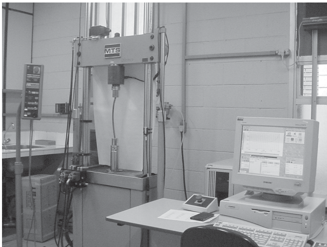
Fig. 1B – Montagem completa do dispositivo na máquina de ensaios
